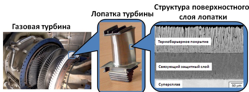
Рис. 1. Фотография турбины, её лопатки и структуры поверхностного слоя лопатки
